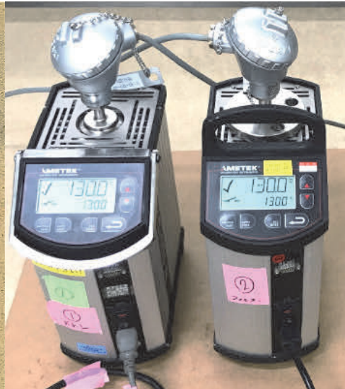
図9-2 温度キャリブレータ
