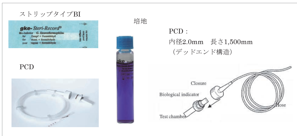
図13-2 EN 867-5に準拠したPCDとISO 11138-5に準拠したBI 5)
