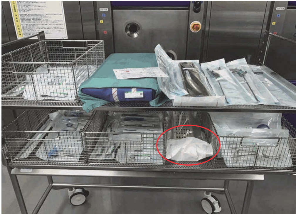
図1-5 RMDのチャンバー内積載法の例。丸印はマスター製品（写真提供：大阪大学）
