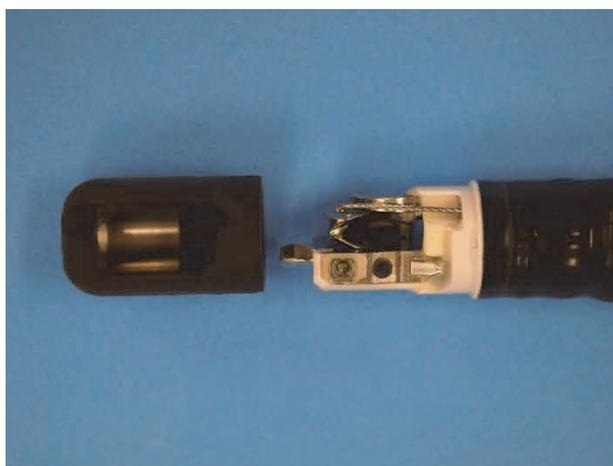
図4-3 鉗子起上機構の先端キャップ
