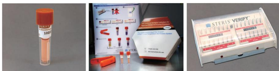
図8-3 過酸化水素ガス低温滅菌器用のBI（24時間培養）および培養器の例
