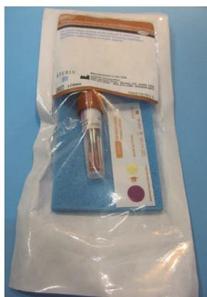
図8-2 過酸化水素ガス低温滅菌器用テストパックの例
