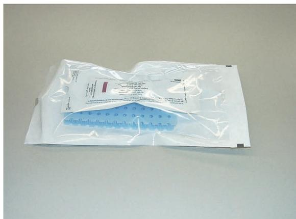
図7-2 過酸化水素低温ガスプラズマ滅菌器用テストパックの例
