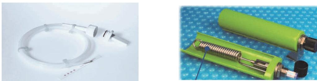
図9-2 EN867-5基準のPCDの例
